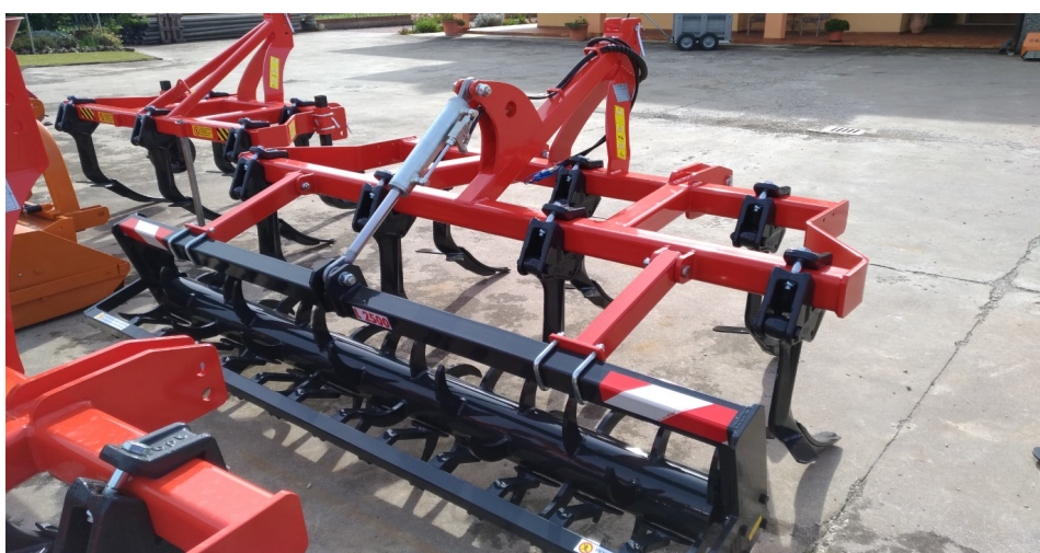
Rullo posteriore con registro idraulico
